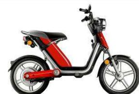
**e-MO Plus** a été pensé pour un usage plus intensif au cœur des villes. Doté d'un équipement musclé avec un frein à disque à l'avant, un double-amortisseur à l'arrière et une fourche hydraulique, ce scooter électrique est parfaitement adapté à une utilisation quotidienne.
